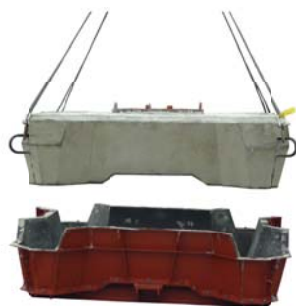
脱型・中筒取り外し
