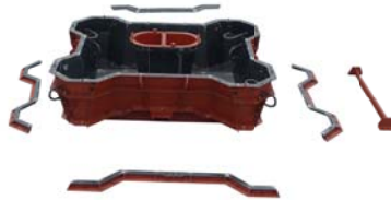
吊り鉄筋・中筒設置
