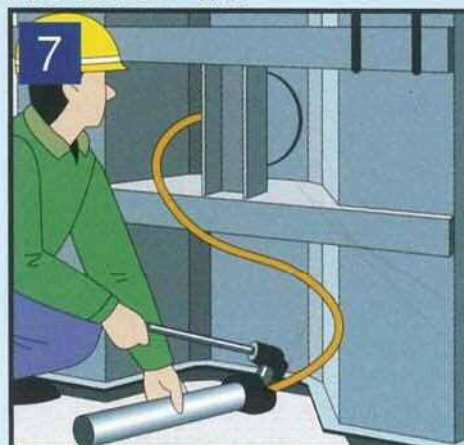
ジャッキによる筒のとりはずし
